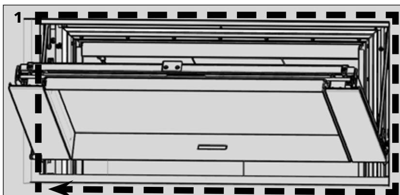
Ouvrir la porte et vérifier que le joint d'étanchéité en silicone blanc soit toujours en bon état.
