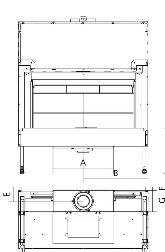
Dimensions de la boîte d'air en configuration "buslot" de Ø100mm et Ø160mm
