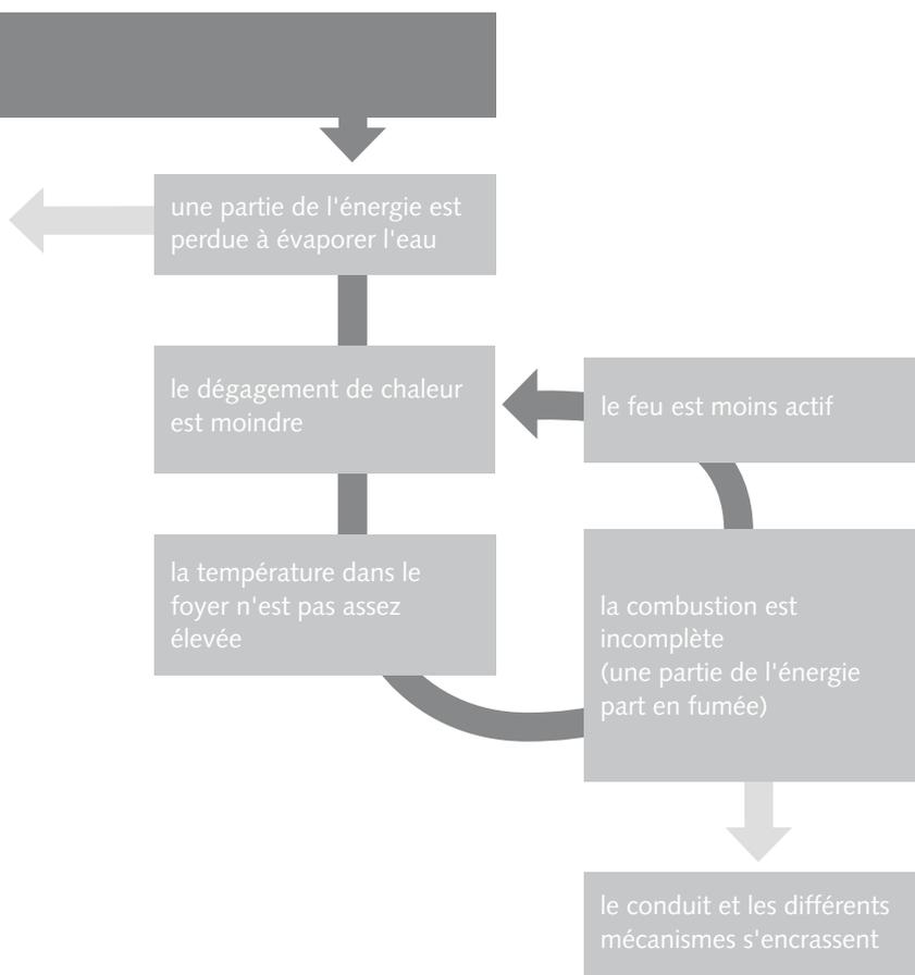
Le cercle vicieux ci-dessus illustre les conséquences négatives d'un foyer alimenté par du bois trop humide. En brûlant des bûches à 30% d'humidité plutôt que des bûches à 10%, il y a une perte de 25% d'énergie au niveau de la bûche, et une perte de 25% supplémentaire dûe au mauvais fonctionnement du foyer.
